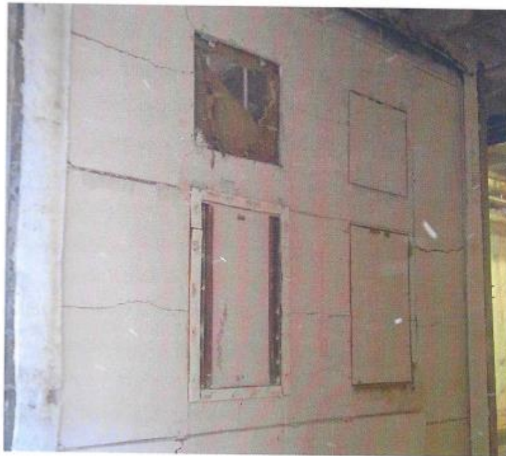
Figure 22 – Coté exposé de l'échantillon essayé.
