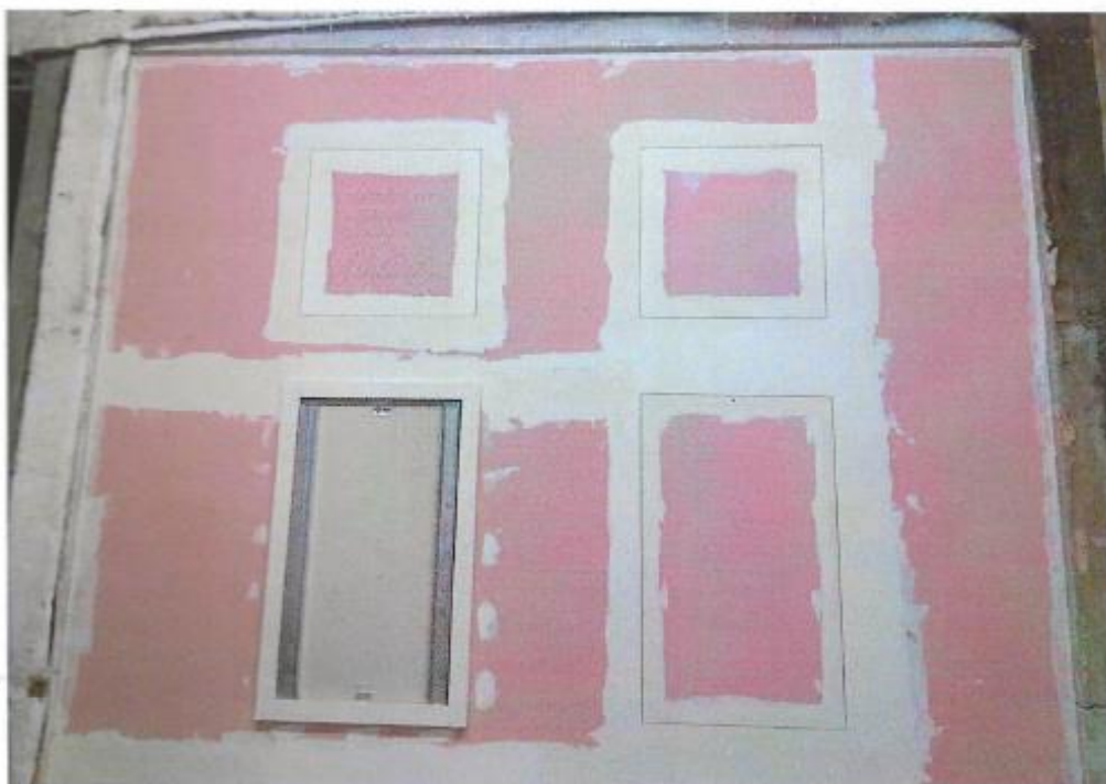
Figure 3 – Coté exposé de l'échantillon à essayer.
