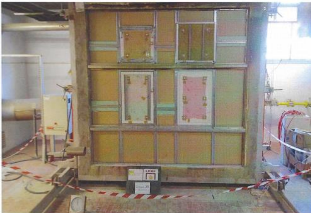
Figure 2 – Coté non exposé de l'échantillon à essayer.
