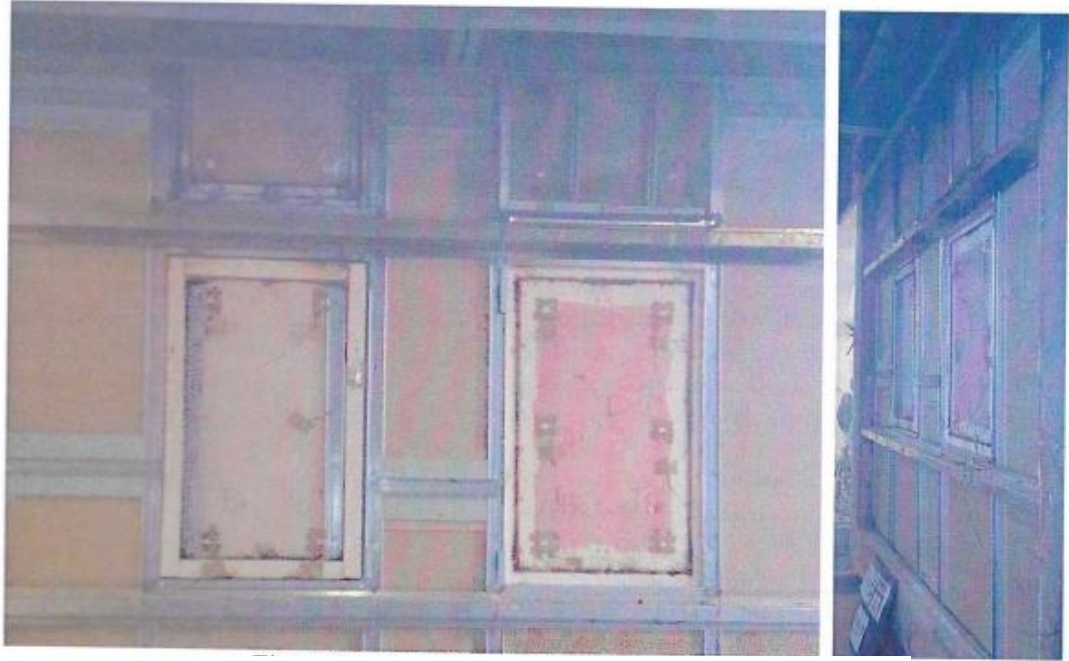
Figure 21 – Coté non exposé de l'échantillon essayé.
